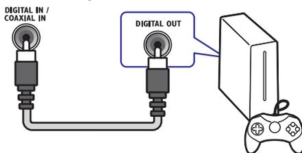
1. Izmantojot koaksiālo kabeli, savienojiet **COAXIAL** ligzdu uz jūsu SoundBar atskaņotāja ar **COAXIAL/DIGITAL OUT** ligzdu uz televizora vai citas ierīces.
