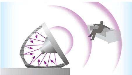
La face arrière soigneusement incurvée de ce haut-parleur avec station d'accueil Philips crée une structure acoustique permettant de reproduire le son avec une efficacité surprenante. Cette conception renforce la rigidité du boîtier du haut-parleur réduisant ainsi considérablement la résonance interne afin d'éliminer les vibrations et les distorsions sonores. Vous profitez ainsi d'un son d'une qualité incomparable grâce à un haut-parleur par ailleurs agréable à regarder.
