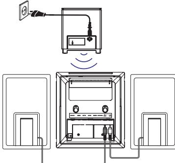
1. Įrenginį viršutine dalimi į apačią padėkite ant lygaus ir stabilius paviršiaus. Tada nuimkite apsauginę medžiagą įrenginio gale, kad apnuogintume lizdus ir paruošumėte juos sujungimui.
