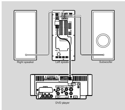
● С помощью прилагаемого кабеля DIN соедините разъем DIN проигрывателя DVD и разъем DIN левого громкоговорителя.
