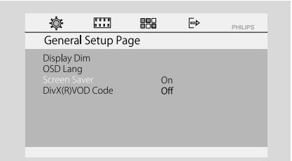
→ **ON:** В режиме STOP, PAUSE или No DISC, если не производится никаких действий в течение примерно 5 минут, включается режим сохранения экрана.
