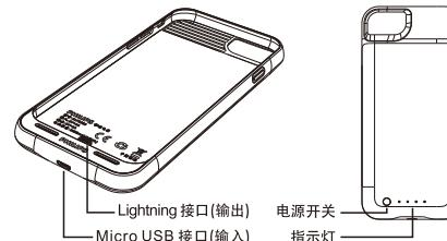
注意：背夹电池开/关机时，请长按电源开关键。
