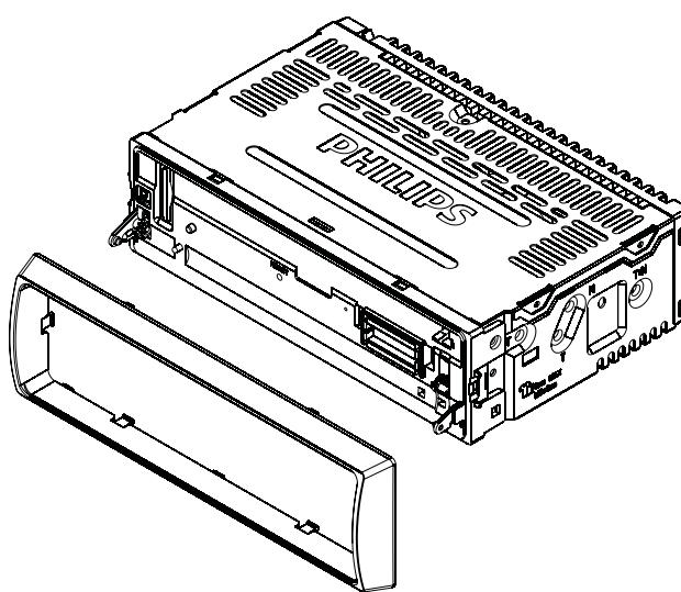
**2** 将面板的左端插入底架直至其正确锁定。
