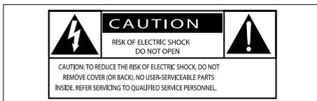
El símbolo del rayo indica que los componentes sin aislamiento dentro del dispositivo pueden generar descargas eléctricas. Para la seguridad de todas las personas de su hogar, no retire la cubierta del producto.
