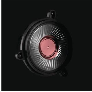
多层驱动单元震膜技术 (LMC) 驱动器具有包裹一层阻尼胶的多层聚合物隔音膜。这些层与阻尼胶一起构成灵活的边界，吸收并抑制任何升高的频率，形成平滑平坦的频率响应，进而提供更均衡、自然和精确范围的高频音效。
