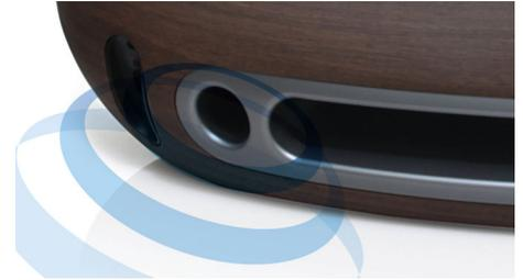
A carga acústica Bass Reflex usa um tubo de graves ajustado ao volume acústico da caixa do alto-falante, para reproduzir graves profundos por alto-falantes compactos. O tubo de graves cuidadosamente projetado facilita o fluxo de ar e proporciona graves profundos e impactantes, mesmo com som alto, ao mesmo tempo em que minimiza a turbulência de ar, que pode causar distorção.
