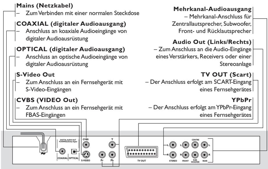
**Achtung: Berühren Sie niemals die Stifte in den Buchsen auf der Rückseite des Geräts. Elektrostatische Entladungen können zu irreparablen Schäden am Gerät führen.**
