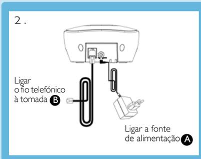
3. Ligar a outra extremidade do fio telefónico à tomada do fio do telefone e a outra extremidade do cabo de alimentação à tomada de electricidade.
