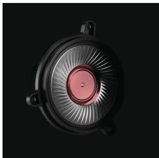
Os diafragmas com controlo de movimento de várias camadas consistem em diafragmas em polímeros distribuídos em camadas com uma base de gel amortecedor. Estas camadas formam uma barreira flexível, juntamente com o gel, que absorve e amortece quaisquer energias exageradas, o que resulta numa frequência de resposta suave e mais uniforme.
