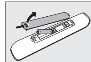
Remarque: Si les indicateurs d'appareil dans la fenêtre du sélecteur (TV, DVD, STB et VCR) clignotent quatre fois après chaque pression de touche, c'est que la télécommande indique que ses piles sont faibles. Remplacez les piles par deux piles AAA neuves.
