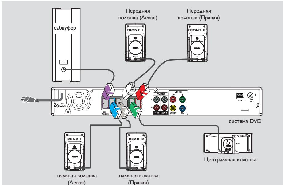
Подсоедините входящие в комплект колонки с помощью входящих в комплект кабелей. При этом цвета кабелей колонок должны соответствовать цветам разъемов. Неизолированный конец провода колонки вставляйте в разъем полностью.
