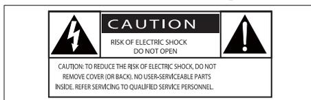
Este "raio" indica a presença de materiais sem isolamento na parte interna da unidade, o que pode causar choque elétrico. Não remova a tampa do produto, pois isso pode comprometer a segurança de toda sua família. O "ponto de exclamação" serve de alerta para recursos cuja documentação deve ser lida atentamente a fim de evitar problemas de operação e manutenção.
