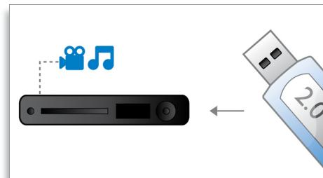
Evrensel Seri Veri Yolu veya USB, PC'leri çevre birimlerine ve elektronik cihazlara kolayca bağlamak için kullanılan bir protokol standartıdır. Yüksek Hızlı USB cihazların veri aktarım hızı, orijinal USB'lerin 12 Mb/s üzerine çıkararak 480 Mb/s'ye kadar ulaşır. Yüksek Hızlı USB 2.0 Bağlantısı ile yapmanız gereken tek şey, USB cihazınızı takmak, film, müzik veya fotoğrafı seçmek ve hemen oynatmak.
