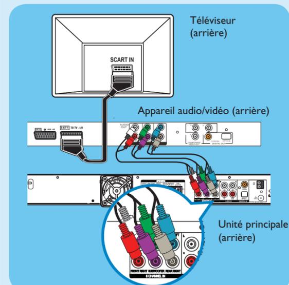
**Remarque** Démarrez la lecture de l'appareil connecté. Appuyez plusieurs fois sur la touche **DISC/DI** de la télécommande jusqu'à ce que « DISC 6CH » s'affiche.
