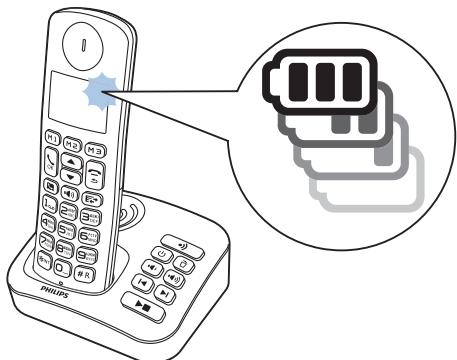
Значок аккумулятора отображает текущий уровень заряда аккумулятора.
