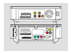
將固定在DVD燒錄機底部的兩根地線連接到 HDD(硬碟)背部的接地端口(→)。然後,按 上圖所示擰緊螺絲確保牢固連接。
