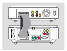
● 透過匹配插針,以提供的40-pin及36-pin IDE扁平控制線,連接在微型可錄製影院後面標示為 CONTROL CABLE A及CONTROL CABLE B的端子至功率放大器後的相應接頭。
