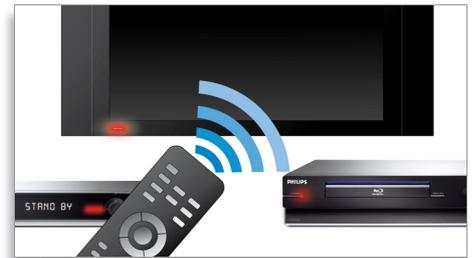
O EasyLink permite controlar vários dispositivos com um controle remoto. Ele usa o protocolo padrão da indústria HDMI CEC para compartilhar funcionalidades entre dispositivos pelo cabo HDMI. Com o toque de um botão, você pode operar simultaneamente todos os seus equipamentos habilitados para HDMI CEC conectados. Funções como modo de espera e reprodução agora podem ser executadas com absoluta facilidade.
