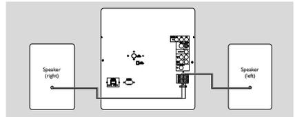
Conecte los cables de los altavoces a los terminales de los ALTAVOCES (FRONTALES), el altavoz derecho conectado a "R" y el altavoz izquierdo a "L", el cable de color (señalado) a "+" y el cable negro (no señalado) a "-". Introduzca por completo la parte rayada del cable del altavoz en el terminal según se muestra.
