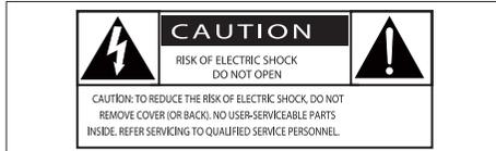
Ce symbole éclair signifie que les composants non isolés de votre appareil peuvent provoquer une décharge électrique. Pour la sécurité de votre entourage, ne retirez pas le couvercle du produit.
