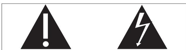
O símbolo com a forma de raio indica a existência de material não isolado no interior da unidade que pode causar choques eléctricos. Para a segurança de todas as pessoas da sua casa, não retire o revestimento do aparelho. O “ponto de exclamação” chama a atenção para funcionalidades acerca das quais deve ler atentamente a documentação fornecida para evitar problemas de funcionamento e manutenção.
