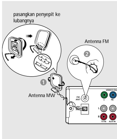
① Sambungkan antena loop **MW** yang dibekalkan kepada bincu **MW**. Letakkan antena loop **MW** di atas para dan pasangkannya kepada kaki atau dinding.
