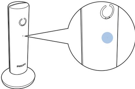
Wenn das Mobilteil richtig in die Basisstation gesetzt wurde, ertönt ein akustisches Signal (siehe 'Einstellen des Docking-Tons' auf Seite 23). Die LED an der Rückseite des Mobilteils leuchtet einmal auf.
