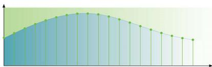
El muestreo a 192 KHz permite obtener una representación precisa de las curvas de sonido originales. En combinación con una resolución de 24 bits, se captura más información de la
