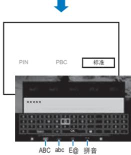
**中文** 如果你选择**标准**，输入密码。在遥控器上，按**◀▶**选择输入模式。输入文本时，按**▲▼◀▶OK**选择屏幕键盘上的按键。完成文本输入时，在屏幕键盘上选择**OK**。
