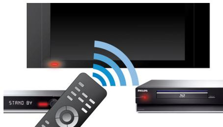
EasyLink te permite controlar varios dispositivos tales como reproductores de DVD, Blu-ray, televisores, etc. con un solo control remoto y utiliza el protocolo estándar HDMI CEC para que los dispositivos conectados compartan las mismas funciones a través de un cable HDMI. Con sólo presionar un botón, puedes controlar todos los equipos HDMI CEC de forma simultánea y las funciones de modo de espera y de reproducción son muy fáciles de usar.
