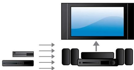
只需将播放机的音频 HDMI x2 输出插入非 3D AV 接收器的接口, 即可享受栩栩如生的 3D 播放和水晶般清晰的 5.1 或 7.1 音频。
