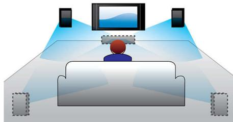
AC Dolby Virtual — это усовершенствованная технология аудио виртуализации, которая обеспечивает насыщенный, невероятно объемный звук из 2-х акустических систем. Высокотехнологичные пространственные алгоритмы точно повторяют акустические характеристики, которые встречаются в идеальной 5.1-канальной среде. Воспроизведение DVD улучшено благодаря
