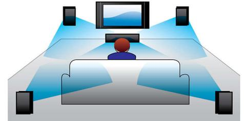
Il decodificatore incorporato Dolby Digital elimina la necessità di un decodificatore esterno, poiché è in grado di elaborare tutte le informazioni dei sei canali audio e garantire un audio surround potente, naturale ed estremamente realistico. Dolby Pro Logic II genera cinque canali di elaborazione surround da qualsiasi sorgente stereo.
