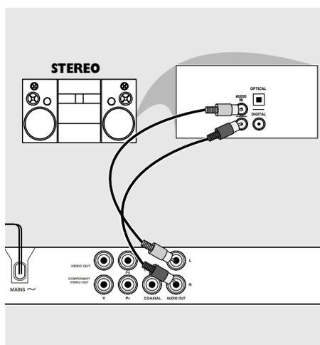
O aparelho estéreo tem tomada Dolby Pro Logic ou entradas de áudio esquerda e direita (Audio In Left/Right)
