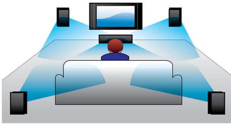
Вграден DTS и Dolby Digital декодер премахва нуждата от външен декодер, като обработва всичките шест канала звукова информация, за да осигури пространствено звуково усещане и поразително естествено чувство за реализъм и динамика на обкръжението. Dolby Pro Logic II осигурява петканален звук от произволен източник на стереосигнал.
