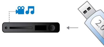
Универсалната серийна шина или USB е стандарт за протокол за свързване на компютри, периферия и потребителска електроника. Устройствата с високоскоростен USB имат скорост на пренос на данни до 480 Mbps - срещу скромните 12 Mbps на тези с първоначалния USB интерфейс. С връзката с високоскоростен USB 2.0 всичко, което трябва да направите, е да включите USB устройството, да изберете филма, музиката или снимките и да ги гледате и слушате.
