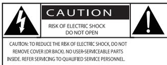
Символ "молния" указывает на наличие изолированных материалов в устройстве и на опасность поражения электрическим током. В целях безопасности не снимайте корпус.
