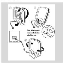
Die Antenne so weit wie möglich von Fernsehgeräten, Videorecordern oder anderen Störquellen entfernt anbringen.
