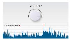
抗削顶失真功能让您可以大声播放音乐并保持优质音效,即使是在电池电量不足时。该功能可接受 300 毫伏至 1000 毫伏等一系列输入信号,让您的扬声器丝毫不受失真的影响。该内置功能可监控通过放大器的音乐信号,将信号峰值控制在放大器的范围内,防止由削顶造成的音频失真,而丝毫不影响响度。便携式扬声器再现音乐峰值的能力会随着电池电量的下降而降低,而抗削顶失真功能却能减少因电池电量不足导致的峰值下降,确保欣赏无失真的音乐。
