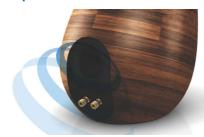
La charge acoustique Bass Reflex utilise un évent de basses adapté au volume acoustique de l'enceinte afin de reproduire des basses profondes avec une enceinte compacte. L'évent de basses soigneusement conçu et profilé facilite le passage de l'air et permet d'obtenir des basses profondes et puissantes, même lorsque le volume est élevé, tout en réduisant les turbulences d'air, sources de distorsion.
