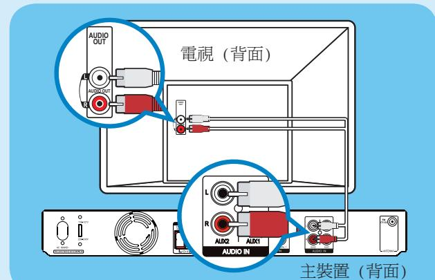
**備註** 觀賞電視節目時，可以重複按下遙控器的 DI/AUX，直到畫面顯示‘AUX 1’或‘AUX 2’，便能聆聽揚聲器的音訊輸出。
