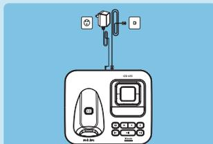
2. Ligue o cabo de linha telefónica e o cabo de alimentação aos seus conectores correspondentes na parte de trás da estação de base.
