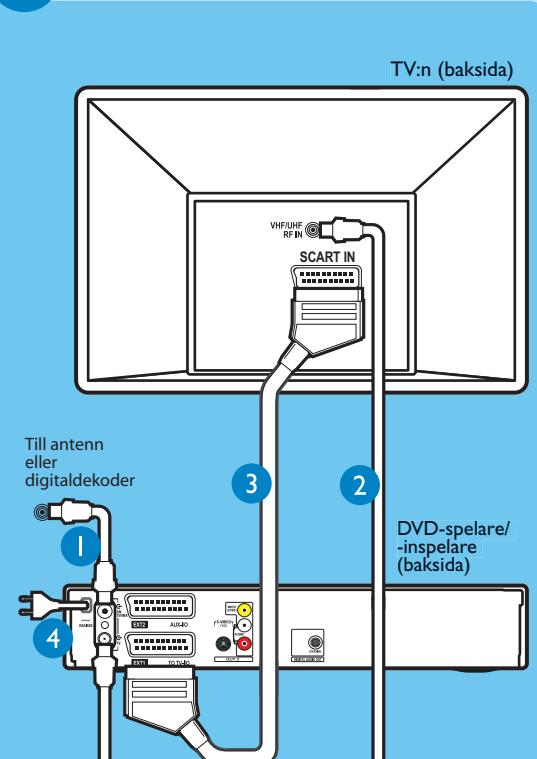
1 Anslut antennkabeln till uttaget märkt **ANTENNA** på inspelaren.
