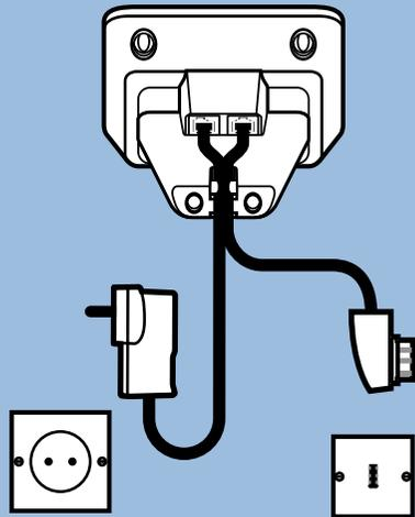
Das jeweils andere Ende der Kabel in die entsprechenden Anschlussdosen, Telefonanschluss und Stromversorgung, stecken.
