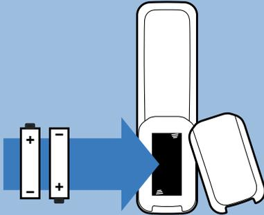
Akkus korrekt einsetzen und Akkufachabdeckung wieder anbringen.
