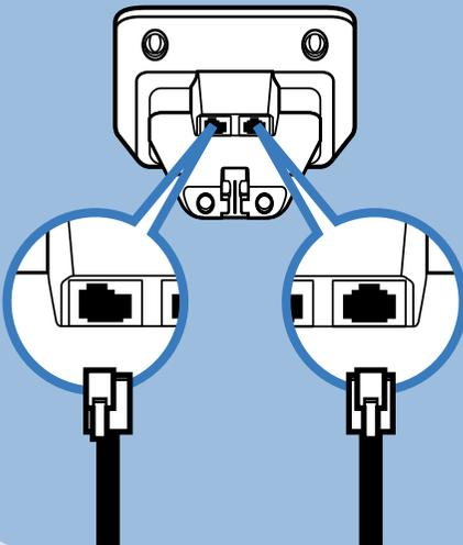
Telefon- und Netzkabelstecker an den entsprechenden Buchsen auf der Unterseite der Basisstation anschließen.
