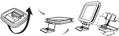
2 Conecte la antena de cuadro MW (AM) a la toma **AMANT** de la parte posterior del sistema Hi-Fi.
