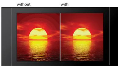
DAC Video 12-bit adalah Konverter Digital ke Analog yang superior yang menjaga setiap detail kualitas gambar asli. Menunjukkan gradasi warna yang lembut dan halus, menghasilkan gambar yang alami dan penuh warna. Pembatasannya 10bit DAC yang biasa menjadi terlihat menggunakan layar lebar dan proyektor.
