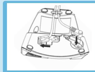
2. Conecte el cable de línea y el cable de alimentación a sus conectores correspondientes en la parte posterior de la estación base.
