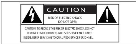
El símbolo del rayo indica que los componentes sin aislamiento dentro del dispositivo pueden generar una descarga eléctrica. Para la seguridad de todas las personas de su hogar; no quite la cubierta.
