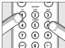
**2** Pulse las teclas 1 y 6 **simultáneamente durante 5 segundos** hasta que la etiqueta del modo seleccionado parpadee dos veces y luego permanezca encendida.
