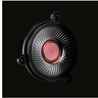
Излучатели с системой контроля LMC (Layered Motion Control) оснащены многослойной полимерной диафрагмой в окружении демпфирующего геля. Эти слои формируют нежесткую граничную поверхность и вместе с гелем устраняют резонанс, за счет чего достигается плавный частотный отклик. В результате воспроизводится сбалансированный, естественный и точный звук при высоких частотах.
