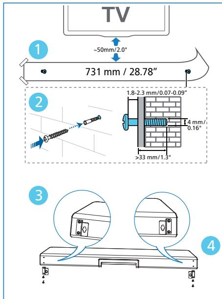
1 Izbušite 2 paralelne rupe (svaka prečnika Ø 3-8 mm u zavisnosti od vrste zida) na zidu.
