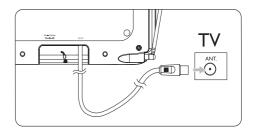
2 Collegare la presa CC all'antenna e l'alimentatore ad una presa da 100-240 V CA.
