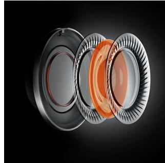
分層動作控制 (LMC) 驅動器具備由一層阻尼膠所包覆的分層聚合物薄膜。不同於傳統單層驅動器的高音域，聲音較渾厚且會重現無法控制的不自然音色，我們的 LMC 驅動器多層薄膜為一層膠形成未固定的邊緣。這層膠可吸收並抑制任何過大的能量，使頻率反應更順暢平穩，也因此達成更平衡、自然且精緻的高音域。
